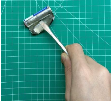
Gambar 3. Proses Pembukaan Baterai
