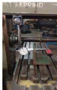
Gambar 11. Pengukuran Ketegaklurusan antara Permukaan meja dan Gerak Vertikal.
