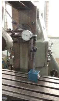
Gambar 15. Pengukuran Rotasi Spindle Utama.
