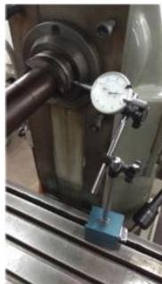
Gambar 13. Pengukuran Rotasi Penyenter Spindle.
