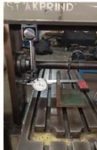
Gambar 7. Pengukuran Kelurusan Terhadap Gerak Vertikal.
