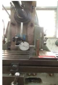
Gambar 9. Pengukuran Ketegaklurusan terhadap Kolom.
