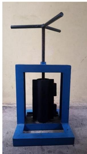
Gambar 2. Alat pencetak briket
