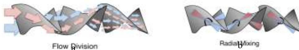
Gambar 3. a. Pembagian aliran, b. pencampuran aliran di dalam *static mixer* (Bor, 1971)
